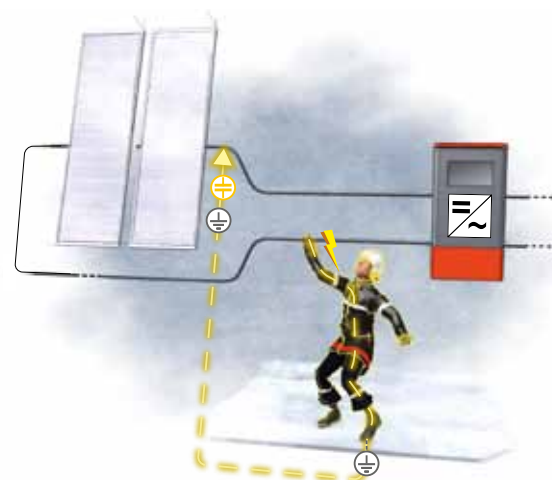
Fig. 20 : Contact direct et décharge capacitive
