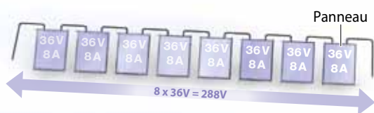
Fig. 4 : Exemple de chaîne photovoltaïque impliquant 8 modules.
