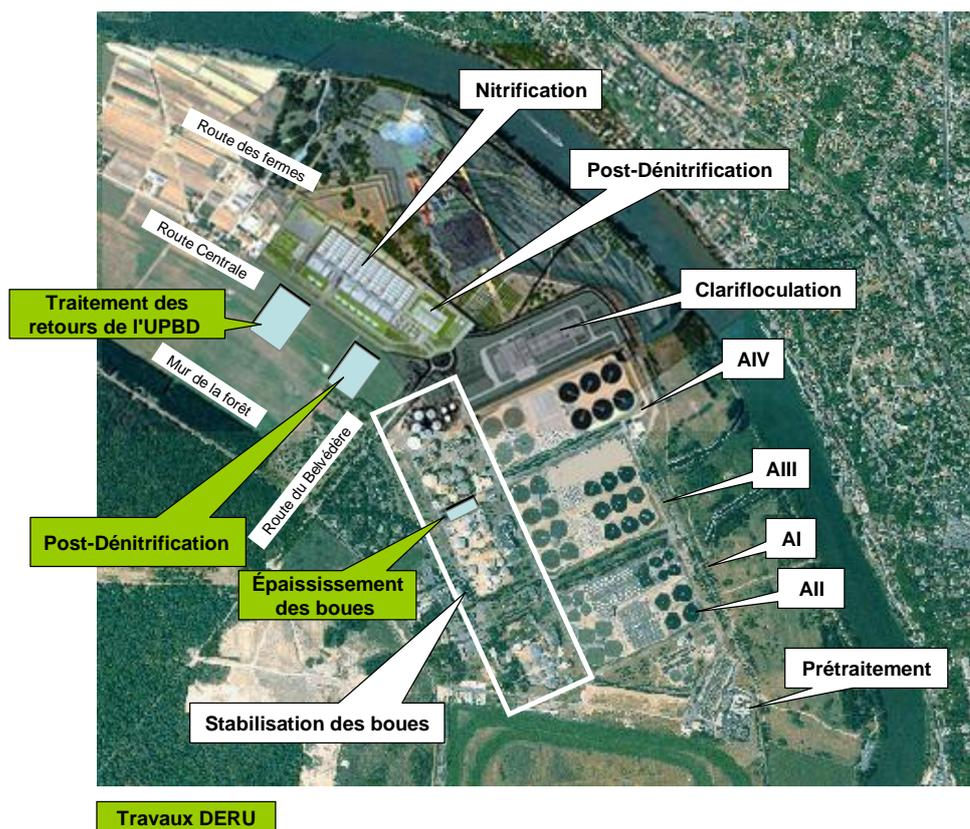
Figure 2 : Vue aérienne de l'Unité de Production des Eaux et des Irrigations (UPEI) – source SIAAP
