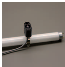
Fig. 42 Détecteur fixé sur un tube TL.
