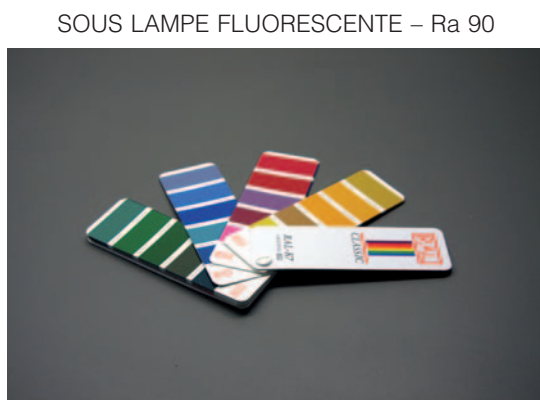
Fig. 49 Eclairage d'un objet sous deux types de sources différentes.
