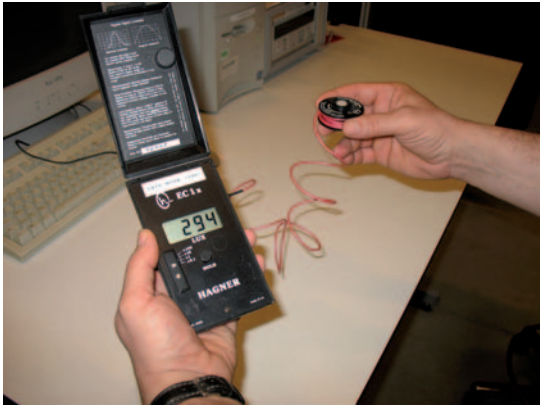
Fig. 52 Mesure d'éclairement au moyen d'un luxmètre.
