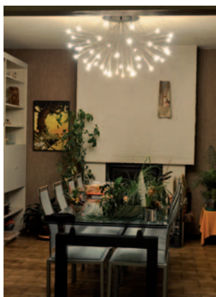
Fig. 32 Luminaires suspendus utilisant des capsules halogènes.
