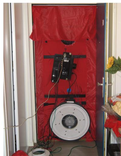
L'idéal est d'effectuer deux tests d'étanchéité : le premier en phase travaux pour repérer les fuites, le deuxième en phase réception pour vérification.
