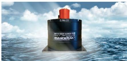
Côté capteurs, Aanderaa propose notamment le capteur Motus Wave Buoy, qui permet de suivre la houle directionnelle, avec l'amplitude et la direction des vagues, ainsi que le courant de surface. Ce capteur se fixe sous une bouée et mesure le courant jusqu'à 60 mètres de profondeur.
