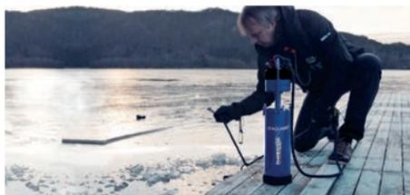
Parmi elles, SeaGuard DCP Wave, plateforme multiparamètre de surveillance du milieu marin, permet de mesurer à la fois la houle directionnelle, les courants, la hauteur des vagues, les marées et la qualité de l'eau, avec un seul et même instrument. Elle est également ouverte à d'autres capteurs tiers et peut être autonome ou installée sur bouée.
